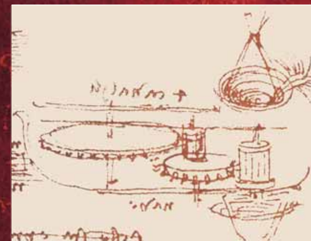
Изобретение центробежного насоса на основе наблюдения неожиданного эффекта: «Когда рука производит вращательное движение в сосуде», «водоворот обнажает дно сосуда, наполовину наполненного водой»
