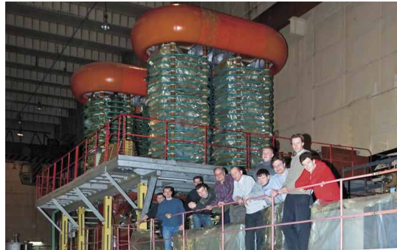
Генератор мегавольтных импульсов ускорителя У-2, используемого для нагрева плазмы в многопробочной ловушке ГОЛ-3
