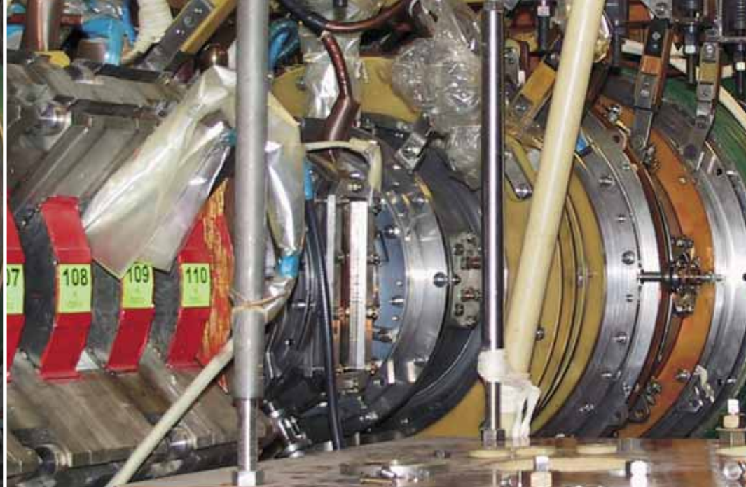
В выходном узле ГОЛ-3 проводятся эксперименты по изучению стойкости материалов под воздействием мощного плазменного потока
