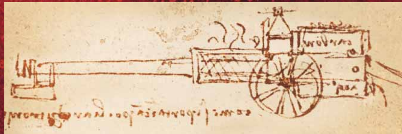
Паровая пушечка Леонардо — первый паровой двигатель, изобретенный и изготовленный более чем за 250 лет до И. И. Ползунова (1763) и Дж. Уатта (1784)
